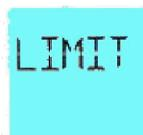
Jestliže se laser nachází mimo rozsah  $\pm 5^\circ$  automatického dorovnání, tak nebude automaticky dorovnán a na displeji se objeví hlášení LIMIT dokud nebude přístroj přestavěn do uvedeného rozsahu.
