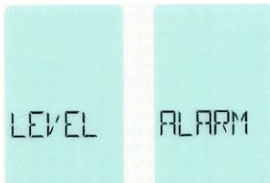
Laser zastaví probíhající operaci, paprsek začne blikat a na displeji se objeví střídavě **LEVEL ALARM**.
